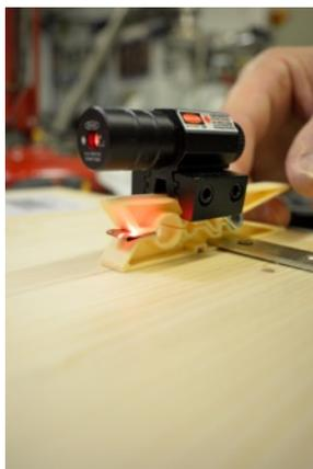
7- Ora inizia il lavoro fino di posizionamento del *beam-splitter*. Operazione da fare accendendo il laser e cercando di far passare i raggi luminosi, sia diretti che riflessi dagli specchi, nel *beam-splitter*. Viene fissato con una basetta rettangolare, bloccata da due sole viti, come mostrato in figura, in modo da lasciargli la possibilità di piccole rotazioni e traslazioni, perché il foro centrale dell'angolare è abbastanza largo e va usato come un'asola.
