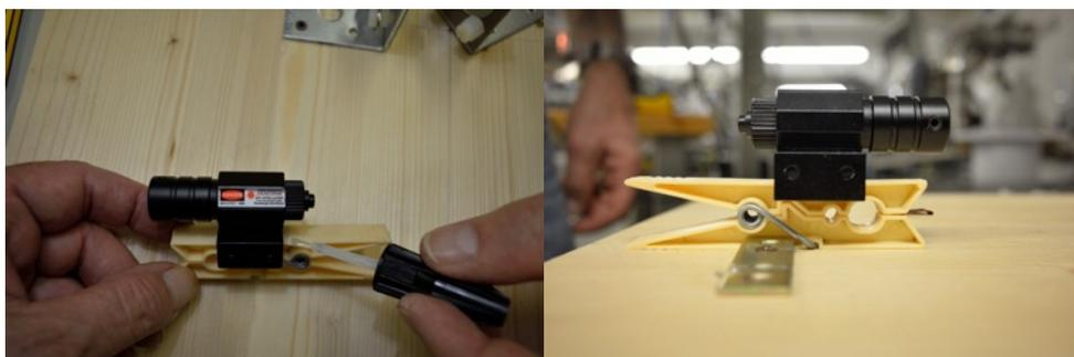
Il sistema viene poi bloccato sulla tavola con una basetta rettangolare, fissata con solo una vite, sempre per lasciare la possibilità di ruotare un pochino il laser su un'asse perpendicolare alla tavola se fosse necessario, previo allentando la vite di serraggio sul legno. Notare lo spessore inserito nella punta della molletta.
